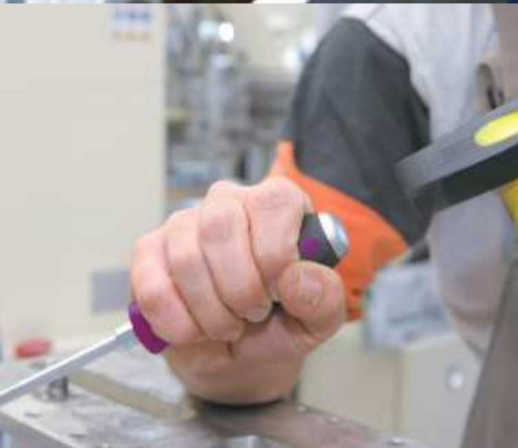
Con caperuzón de montaje continuo
