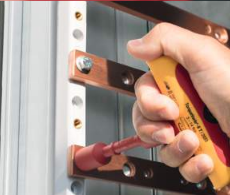
Mango corredizo para transmisión de fuerzas elevada
